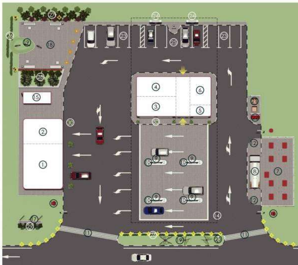
Тип 2. Схема планировочной организации автомобильно-заправочного комплекса
