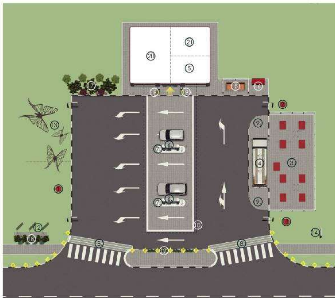
Тип 1.1. Схема планировочной организации городской автомобильно-заправочной станции
